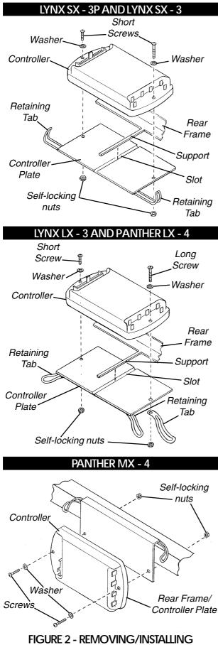
CONTROLLER FROM/TO CONTROLLER PLATE
