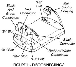
CONNECTING CONTROLLER WIRES
