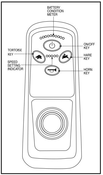
Figure 25. FLIGHT Controller Keypad
